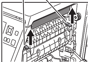
Fixáló egység nyomásállító karjai
