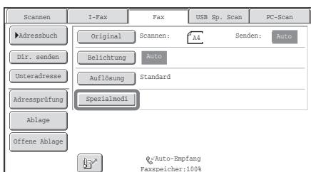
Öffnen Sie zum Verwenden eines Spezialmodus das entsprechende Menü, und berühren Sie das Feld des gewünschten Modus. Das Menü umfasst vier Bildschirme. Mit den Feldern und können Sie zwischen den Bildschirmen wechseln.
