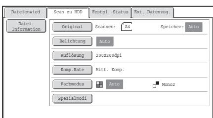
Der Basisbildschirm für die Funktion Scan zu HDD wird angezeigt.
