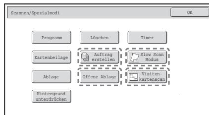
Wenn ein mit umrandetes Feld für einen Spezialmodus berührt wird, wird das Feld markiert, und die Einstellungen werden abgeschlossen. Wenn ein Feld für einen anderen Spezialmodus berührt wird, wird ein Einstellungsbildschirm angezeigt, in dem Sie die Einstellungen für diesen Modus wählen können.
