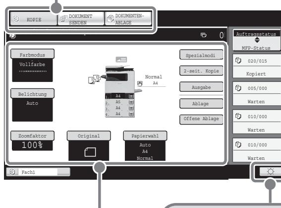
Wenn der Modus des Geräts geändert wurde, wird das Hauptfenster des neu ausgewählten Modus angezeigt. Im Hauptfenster können Funktionen ausgewählt und Einstellungen überprüft werden.
