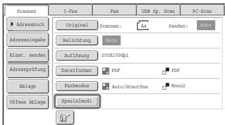
Öffnen Sie zum Verwenden eines Spezialmodus das entsprechende Menü, und berühren Sie das Feld des gewünschten Modus. Das Menü variiert je nachdem, ob der Scan-Modus, Internetfaxmodus oder der Modus USB-Speicher aktiviert ist.
