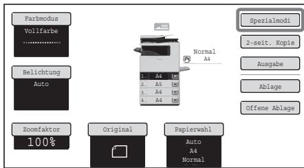
Öffnen Sie zum Verwenden eines Spezialmodus das entsprechende Menü, und berühren Sie das Feld des gewünschten Modus. Das Menü umfasst vier Bildschirme. Mit den Feldern und können Sie zwischen den Bildschirmen wechseln. Berühren Sie zum Öffnen des Spezialmodusmenüs das Feld [Spezialmodi] im Ausgangsbildschirm.
