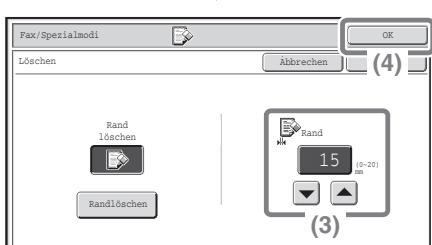
(3) Stellen Sie die Löschbreite auf 15 mm ein, mit Hilfe der ▼ ▲ -Tasten.
