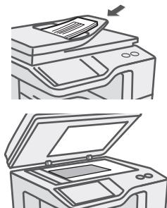
Wenn das X-Maß (Breite) des Dokuments kleiner 89 mm (3-1/2") ist oder das Y-Maß (Höhe) kleiner 100 mm (4") ist, legen Sie das Original auf das Vorlagenglas. Verwenden Sie bei Verwendung des automatischen Originaleinzugs den "Slow Scan Modus" für dünne Originale.
