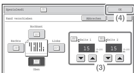
(3) Wählen Sie mithilfe der Felder ▼ und ▲ 15 mm für die Vorderseite und 15 mm für die Rückseite.
