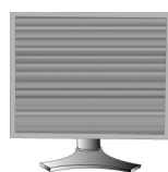
Valeur de FINESSE incorrecte.
