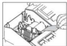
Bei einem Ein-Stationen-Drucker (XE-A177, XE-A207 und XE-A217) bringen Sie die Druckwerkabdeckung wieder an und kontrollieren Sie den korrekten Papierlauf durch Drücken der Papiervorschubtaste.
