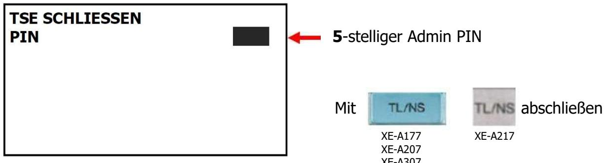
Der Schlussbeleg wird ausgedruckt. Danach steht die Swissbit SD-Karte (TSE) nicht mehr für Registrierungen zur Verfügung.
