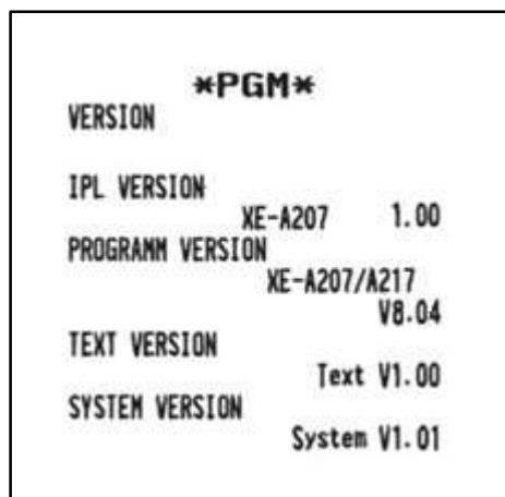
Auf dem Ausdruck steht unter der Zeile „PROGRAMM VERSION“ das Modell und die aktuell installierte ROM Version.
