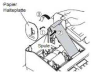
f) Montieren Sie die Halteplatte der Aufwickelspule wieder.
