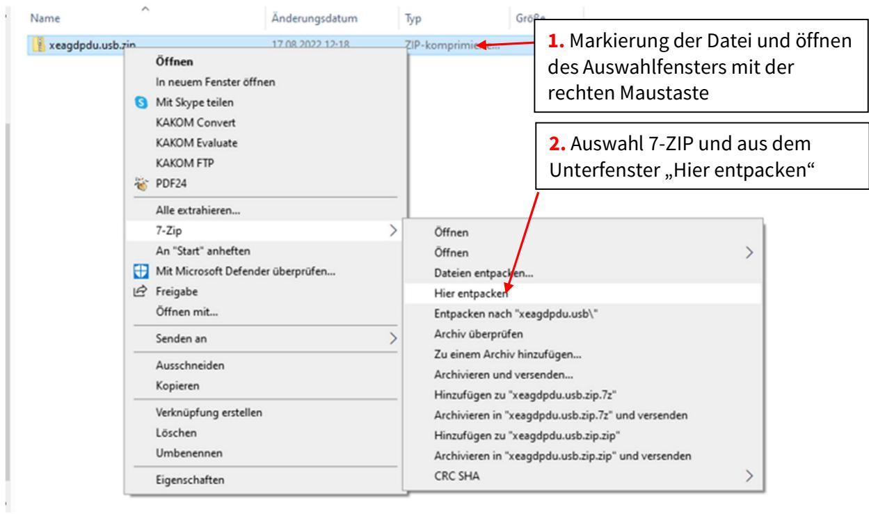
Mit dieser Maßnahme wird die aus dem Internet heruntergeladene gepackte Datei entpackt und die Programmdaten direkt auf den USB- Speicherstick gespeichert.
