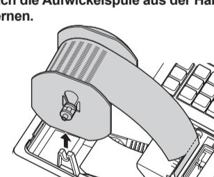
4. Nach dem Abschneiden des Papiers die Papierrolle entfernen. Danach das zurückgebliebene Papier durch Drücken der Taste ↑ entfernen.
